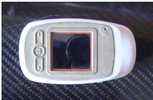
Ces appareils étanches de la taille d'un téléphone portable fleurissent et sont utilisés par de nombreuses nations. Le marché reste très éclectique car ce type d'appareil reste onéreux. Dans ce concentré de technologie, nous retrouvons 11 capteurs différents. En canoë-kayak, nous utilisons essentiellement les données fournies par le GPS 10hz, l'accéléromètre (100ms) et le gyroscope.
